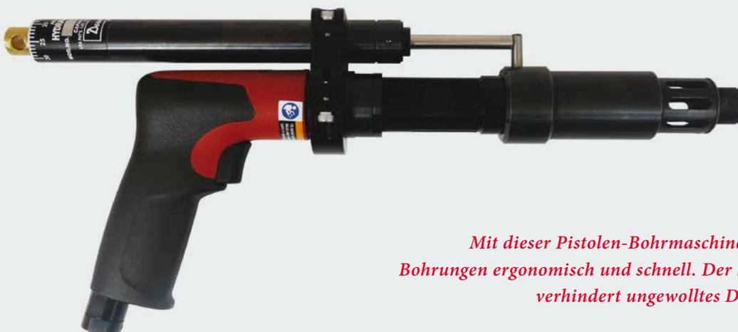
*Mit dieser Pistolen-Bohrmaschine DR500-HCU gelingen präzise Bohrungen ergonomisch und schnell. Der hydraulische Vorschubdämpfer verhindert ungewolltes Durchbohren oder Durchstoßen.*
