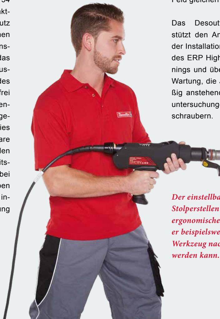
*Der einstellbare Kabelgang verhindert Stolperstellen und unterstützt eine ergonomische Arbeitsposition, indem er beispielsweise bei aufgehängtem Werkzeug nach oben ausgerichtet werden kann.*
