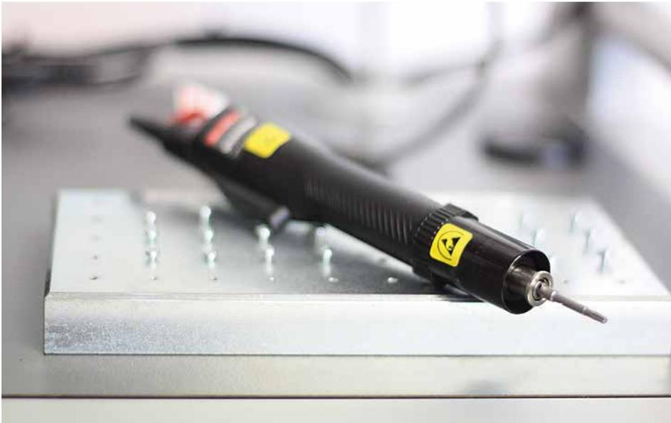
*Die neuen Kleinschrauber stehen für Drehmomente von 0,02 bis 12 Newtonmeter zur Verfügung.*
