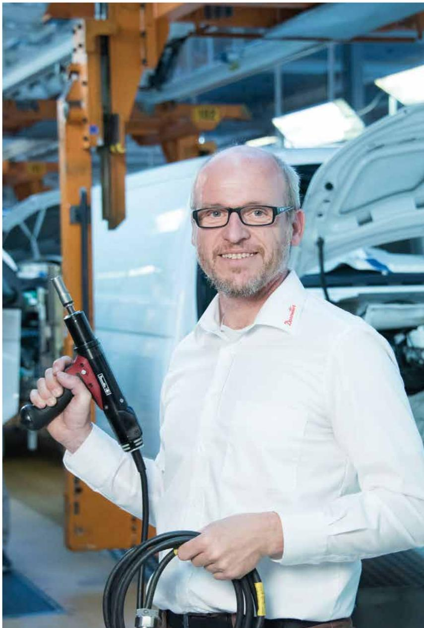
Elektrische Impulsschrauber von Desoutter überwachen die Montage, entdecken Fehler und dokumentieren die Ergebnisse. Gegenüber der Montage mit Druckluftschraubern und Drehmomentschlüssel können Unternehmen die Fertigungszeit verkürzen und die Qualität der einzelnen Schraubenverbindungen steigern. In Hannover montiert VW Nutzfahrzeuge mit diesen Werkzeugen elektrische Anbindungen sowie Schraubverbindungen im Bereich Getriebe/Schaltbetätigung an Motoren von Kleintransportern.
