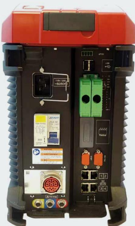
*Die CVI3-Steuerung hat nun auch einen E-Stopp-Schaltkreis (die drei Eingänge unten links), der in das bekannte Gehäuse integriert wurde. Der E-Stopp schaltet die Steuerung sehr schnell ab, wenn dies sicherheitstechnisch erforderlich ist.*
