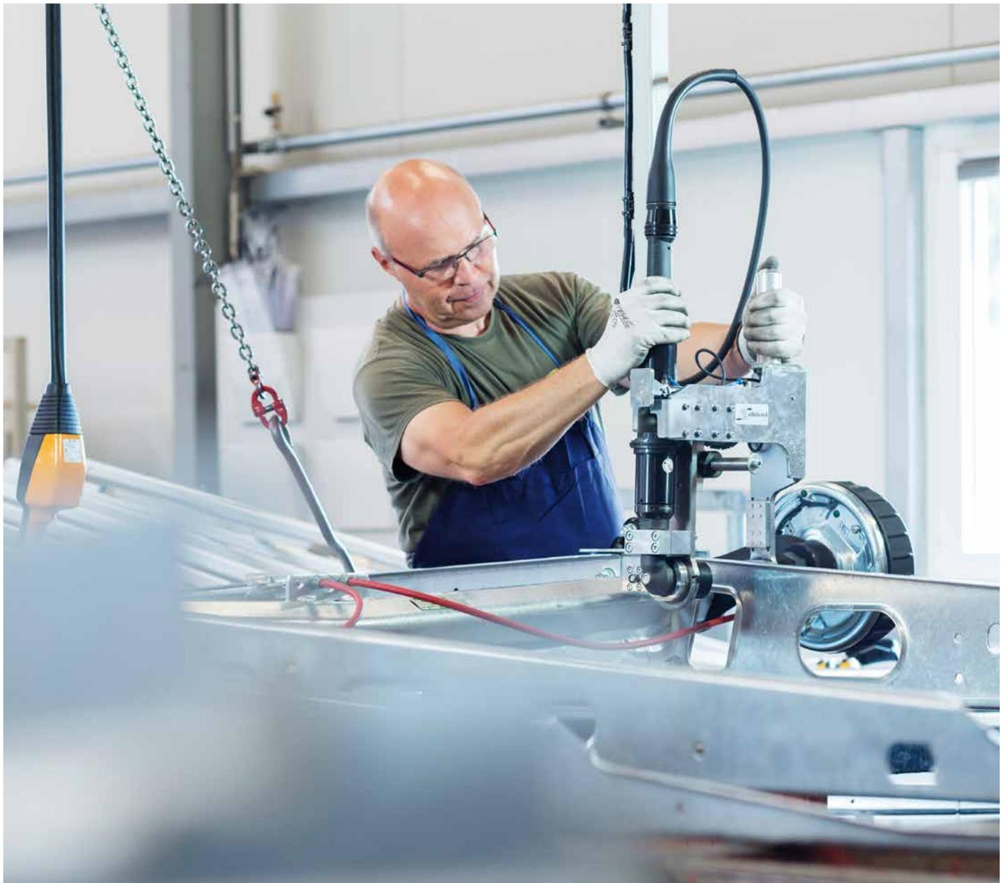
*Durch die drehende Arbeitsweise der gesteuerten Elektroschrauber ist die Montage am Chassis deutlich leiser geworden. Die lauten, weil schlagenden Impulsschrauber werden bei LMC nach und nach aussortiert.*
