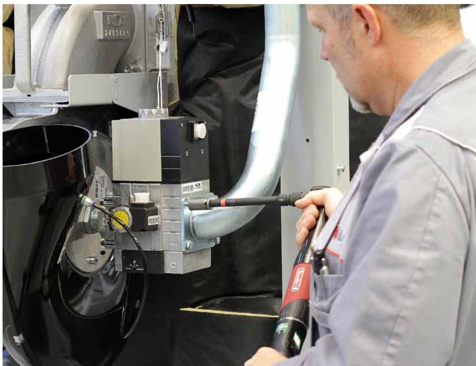
*Die wichtigste Schraubstelle am Gasbrennwertgerät MGK-2 ist für Wolf die Gaszuleitung: Wenn hier im Betrieb Gas austritt, besteht Gefahr für Leib und Leben. Wolf hat die Schraubverbindung daher als sicherheitskritisch eingestuft.*
