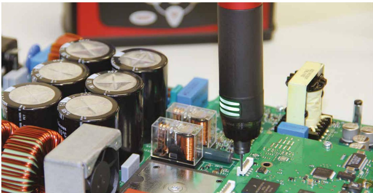
*Der Nano Driver ERXS von Desoutter kann überall dort eingesetzt werden, wo Schrauben mit sehr kleinen Drehmomenten gesteuert angezogen werden und die Montage überwacht und dokumentiert werden muss – etwa in der Elektronik oder Medizintechnik.*
