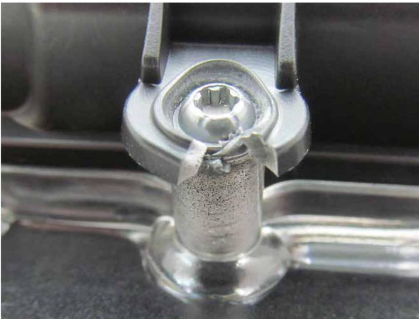
*Worst Case: Wenn die Abschaltgenauigkeit nicht stimmt und die Schraube zu fest angezogen wird, können schlimmstenfalls Klemmteil und Mutterbauteil zerstört werden. Eine einfache Nacharbeit ist dann auch nicht mehr möglich.*
