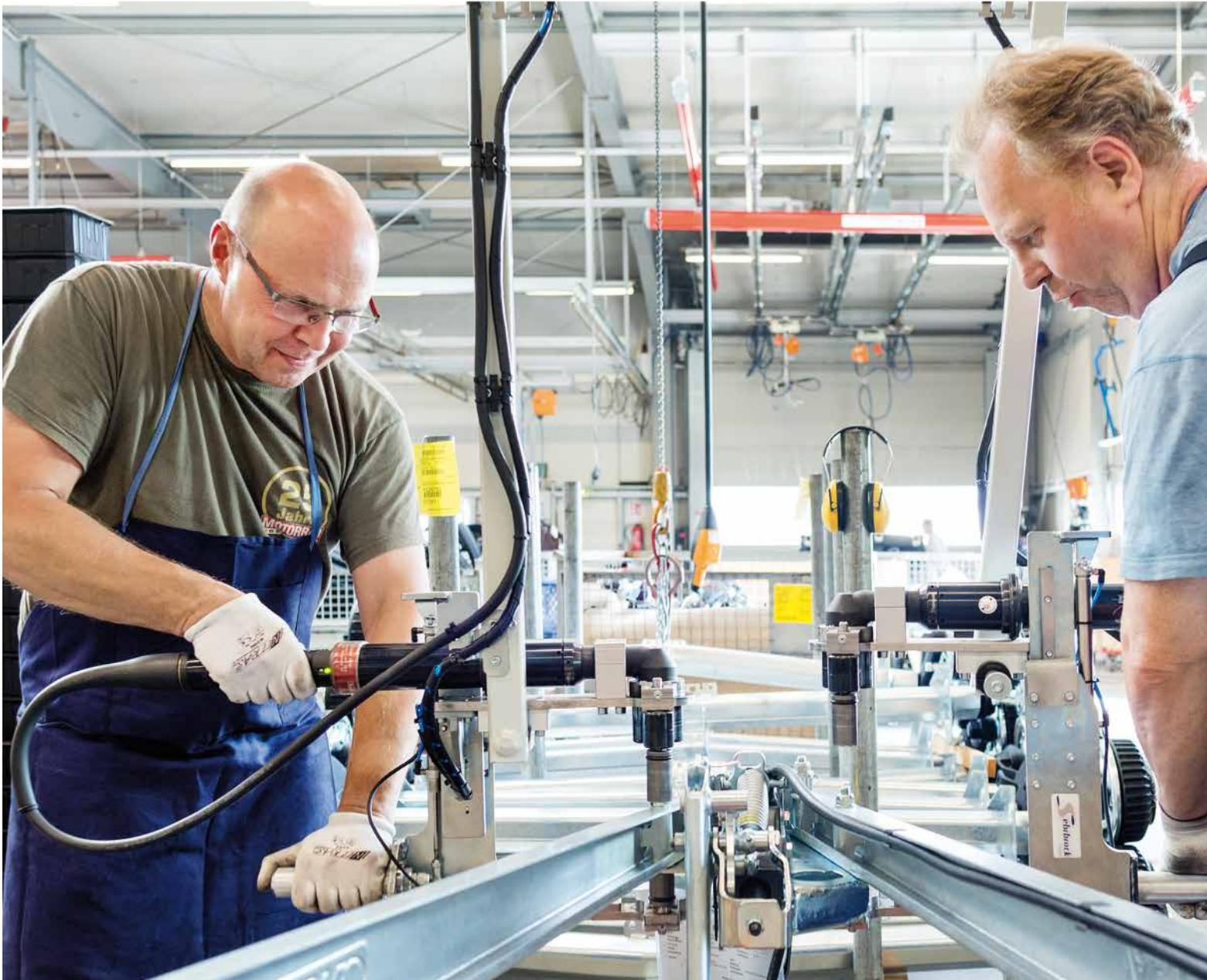
*Mit diesen Schraubsystemen werden über 20 verschiedene Schraubfälle am Chassis abgedeckt. Das Werkzeug, ein elektronisch gesteuerter ERAL-Winkelschrauber von Desoutter, lässt sich mit seinem universellen Gegenhalter in allen Achsen drehen und schwenken.*
