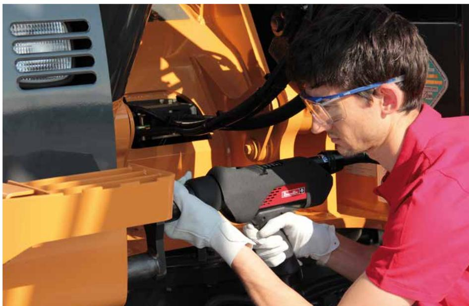
*Der Hochmomentschrauber ERP High Torque eignet sich für alle kritischen Verbindungen im hohen Drehmomentbereich, bei denen es auf Taktzeit, Ergonomie und Rückverfolgbarkeit ankommt.*
