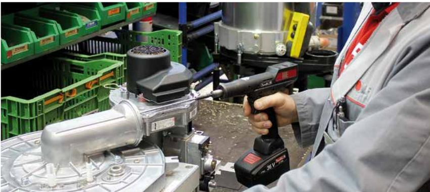
Der Heizungshersteller Wolf montiert die Gaszuleitung seines Gasbrennwertgerätes MGK-2 mit einem dokumentationsfähigen Akkuschauber von Desoutter.
