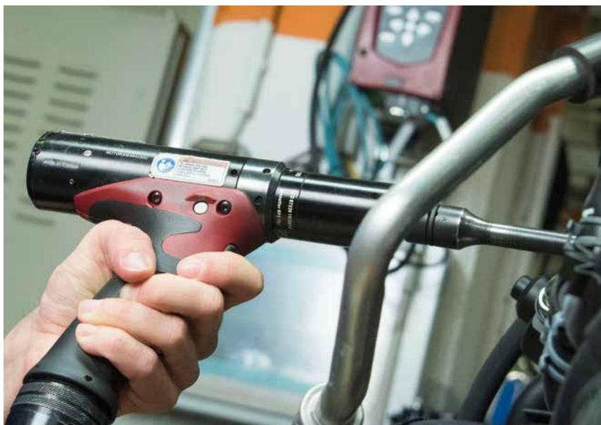
*Mit dem elektrischen Impulsschrauber ELRT werden zum Beispiel Schrauben an Nutzfahrzeug-Motoren angezogen. Das Werkzeug entdeckt Verschraubungs-, Gewinde- oder Materialfehler schon während der Montage.*
