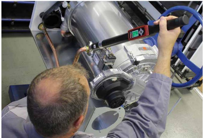
*Für die Montage der sicherheitskritischen Überwurfmutter verwenden die Werker den elektronischen Delta-Drehmomentschlüssel aus dem Desoutter-Programm.*
