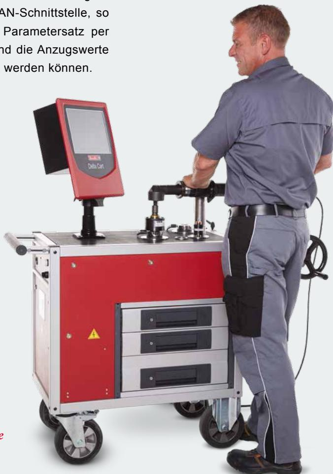
*Mit dem Delta-Cart können Anwender elektrische und pneumatische Schraubwerkzeuge, abschaltende und nicht abschaltende Impulsschrauber, Messschlüssel sowie auslösende Drehmomentschlüssel überprüfen und neu einstellen.*
