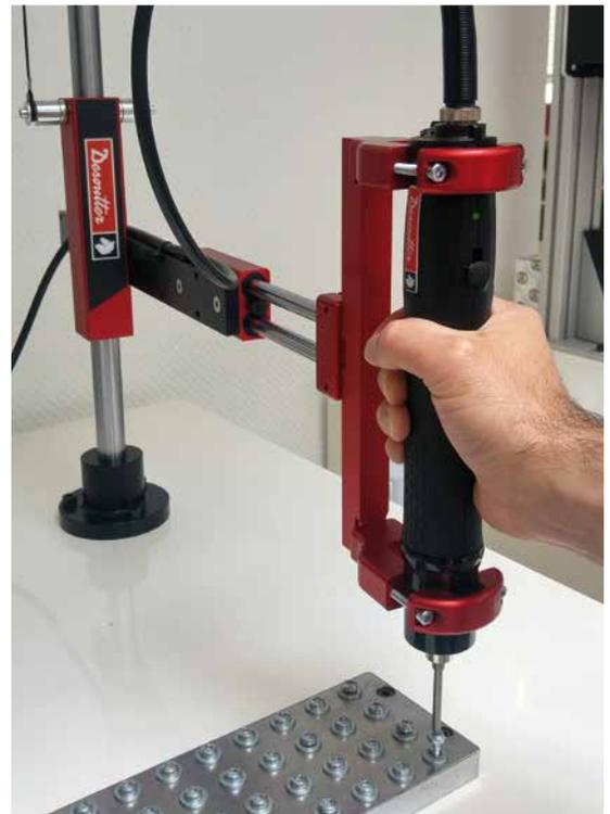
*Ergonomisch und sicher: Wer verhindern will, dass sich der Schrauber verkantet oder bei der Montage schräg steht, kann das Werkzeug oben und unten in eine Werkzeugklemme von Desoutter einspannen.*
