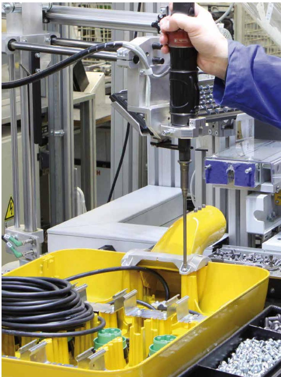
**Desoutter-Schraubtechnik-Experte Sebastian Schlegel sensibilisiert mit diesem Beitrag am Beispiel der Kunststoffdirektverschraubung dafür, den Blick auf das Gesamtsystem „Verbinden von Kunststoffen“ zu schärfen. Dafür betrachtet er den gesamten Prozess näher – von der Herstellung und Verarbeitung von Kunststoffen und deren Werkstoffeigenschaften über den Einfluss der Schraube und die Wahl der richtigen Schraubstrategie bis zur Montage (samt Werker und Werkzeug).**
